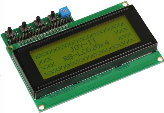
Monochromes 20x04 LC-Display (20 Zeichen auf 4 Zeilen) mit schwarzer Schrift und gelber Hintergrundbeleuchtung. Zusätzlich 4 frei verwendbare Knöpfe, welche angebunden an GPIO 4, GPIO 10, GPIO 9 und GPIO 16 sind. Die genaue Kontrasteinstellung ist möglich mittels Mehrgangpotentiometer. Das Display ist direkt aufsteckbar auf Raspberry Pi Header und kompatibel mit allen Raspberry Pi Versionen.
