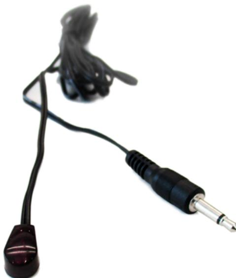
Mit der externen IR-Sendediode können Sie Ihre Infrarot-Geräte wie TV, HiFi-Anlage usw. auch dann komfortabel per Smartphone und Tablet steuern, wenn sich das mediola<sup>®</sup> AIO GATEWAY nicht im direkten „Sichtbereich“ der zu steuernden Geräte befindet.
