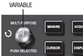
\* Ermöglicht das Triggern komplizierter Signale, z. B. Impulsfolgen. Will man z. B. eine bestimmte Impulsfolge triggern, ist die Hold-off-Zeit darauf einzustellen, siehe Bildbeispiel rechts.
