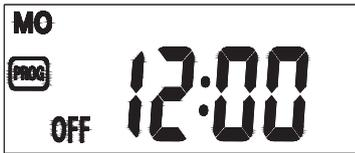
Im Uhrmodus drücken Sie die **PROG** Taste und der Programmierungsmodus wird gestartet, mit dem bis zu 20 ON/OFF Einstellungen pro Tag angeboten werden. Es gibt 15 unterschiedliche Einstellungen in der Woche:
