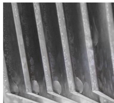
Bild 16: Die kalte Seite des Peltier-elementes. Hier kondensiert das Wasser, wie man auf dem Detailfoto gut sieht.
