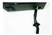
Ziehen Sie die Kabeldurchführung vom Kabel ab. Bekommen Sie den Stecker nicht durch die Kabeldurchführung gezogen, pinnen Sie die beiden Kontakte durch Niederdrücken der Rastenasen an den Kontakten aus dem Gehäuse aus:
