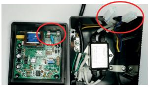
Lösen Sie dann die Befestigungsmutter des grün-gelben Schutzleiters der Lötkolbenzuleitung. Nehmen
