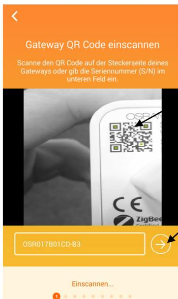
Bitte den QR mittels Kamera scannen oder die Seriennummer manuell eingeben. QR Code und Seriennummer (S/N) befinden sich auf der Rückseite des Gateways
