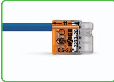
Eindrängigen Leiter gemäß dem aufgedruckten Maß 11 mm abisolieren.
