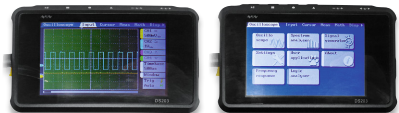
Bild 3: Mini-Oszilloskop auf ARM-Prozessorbasis mit Open-Source-Software
