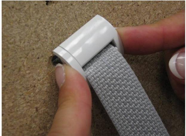
Nehmen Sie die erste Seite der Abdeckung und legen Sie sie über die Rundung des Bürstenhalters (5.). Die Unterseite muss hinter dem Gurt verschwinden. Schieben Sie die Gegenseite seitlich gegen die andere Abdeckung (6.) und schieben Sie beides zusammen, so dass die Befestigungslöcher der Abdeckungen übereinander liegen. (7.)
