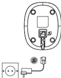
1. Schließen Sie das Netzteil an der Buchse
