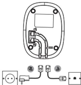
1. Schließen Sie das Telefonkabel an der Buchse
