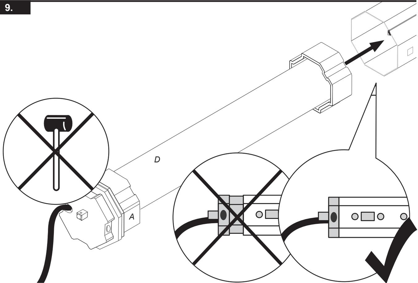
Der Rolladenmotor (D) und Laufring (A) müssen bis zum Anschlag in der Welle stecken. Die Endlageneinstellung ist sonst nicht möglich.
