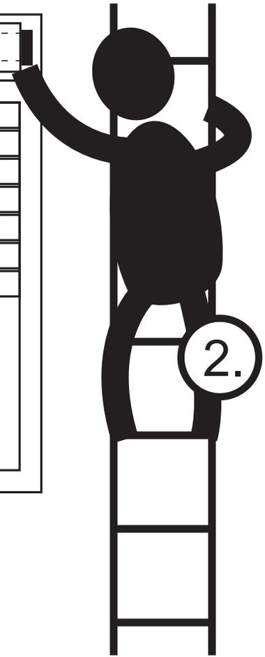
Während der Rollladen hochfährt, den gelben Tippschalter drücken. Wenn der Rollladen bis ca. 20 cm vor dem oberen Endpunkt hochgefahren ist, den Tippschalter loslassen. Rollladen stoppt.
