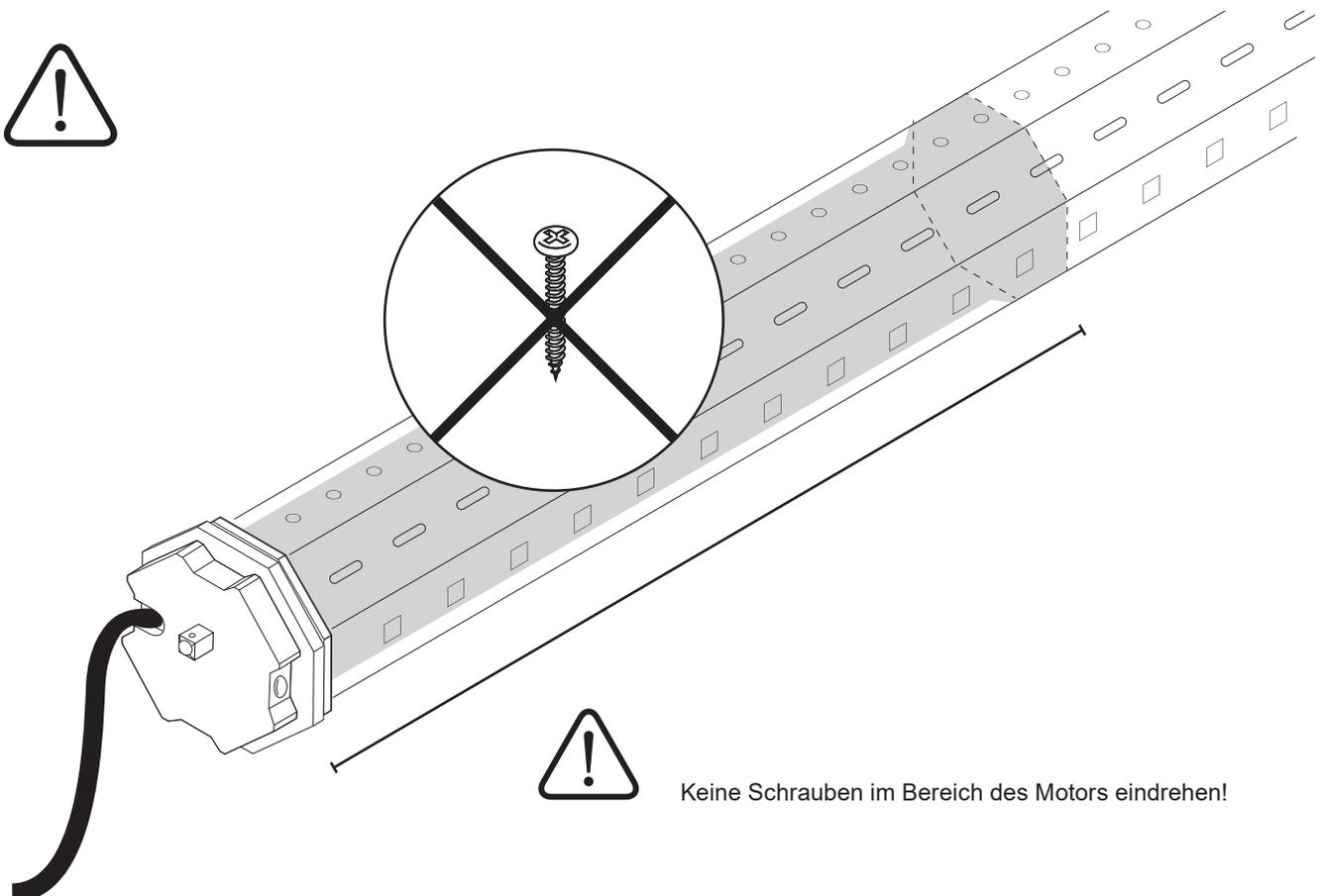
Keine Schrauben im Bereich des Motors eindrehen!
