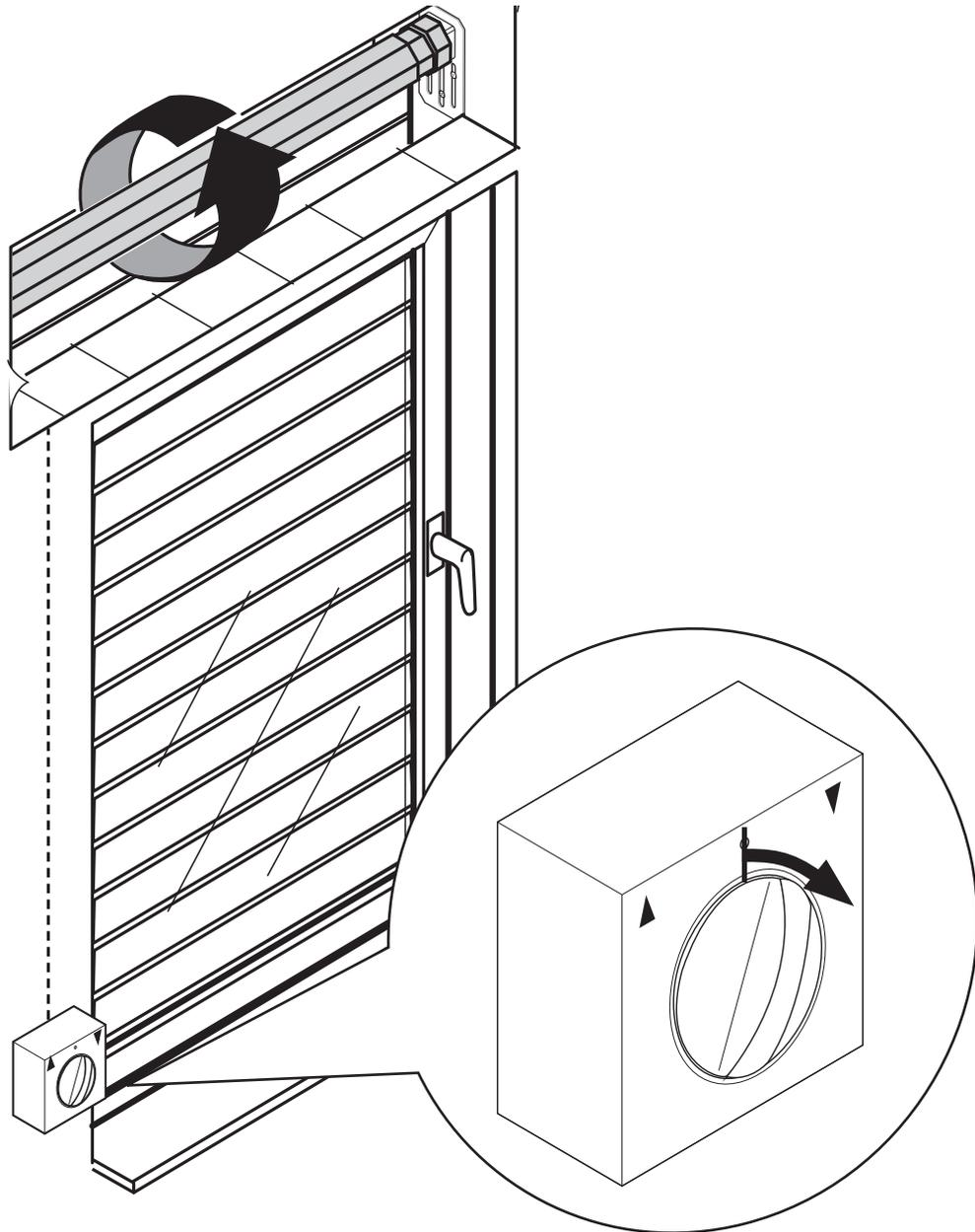
Nach Anschluss der Elektrik muss bei Befehl AB (▼) die Welle in die entsprechende Richtung drehen (s. Abb.).
