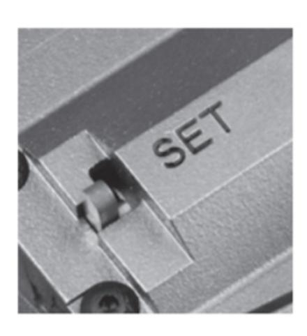
4. Schieben Sie den «RESET» Hebel in die Ausgangsposition.
