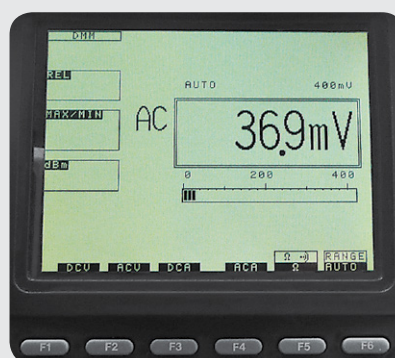
Bild 1: Restwelligkeit bei voller Ausgangsleistung, ein guter Wert
