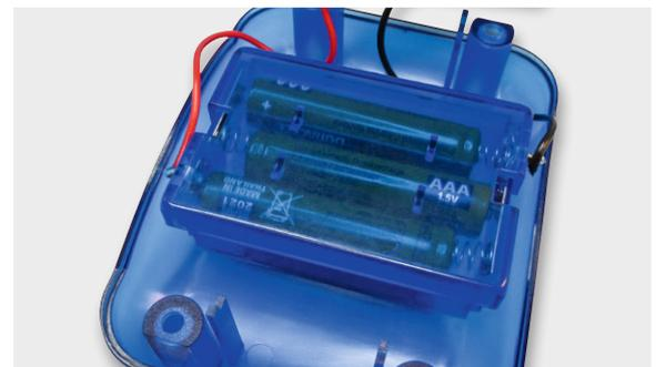
Bild 10: So erfolgt das Aufsetzen des Batteriefachdeckels auf das Batteriefach. Die Anschlüsse ragen dabei seitlich heraus.
