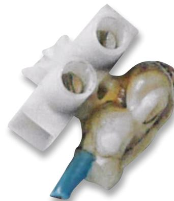
Geschmolzene Schraubklemme nach Verdrahten mit verzinneter Litze
