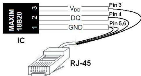
Der Fühler kann optional bis zu 50 Meter mit einem Netzwerkkabel und einem 2 x RJ45-Adapter verlängert werden. (siehe nachfolgende Abb.)
