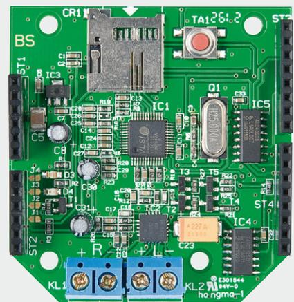
Bild 3: Ansicht der bestückten Platine des ASA1 mit zugehörigem Bestückungsplan
