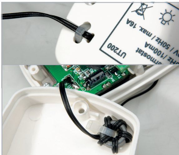
Bild 5: So wird das Sensorkabel um den Ferritring gelegt und mit einem Kabelbinder gesichert. Der Verschluss muss neben dem Ferritring eingelegt werden (siehe Bild unten), damit der Zusammenbau des Gehäuses problemlos erfolgen kann.
