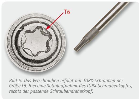
Bild 5: Das Verschrauben erfolgt mit TORX-Schrauben der Größe T6. Hier eine Detailaufnahme des TORX-Schraubenkopfes, rechts der passende Schraubendreherkopf.
