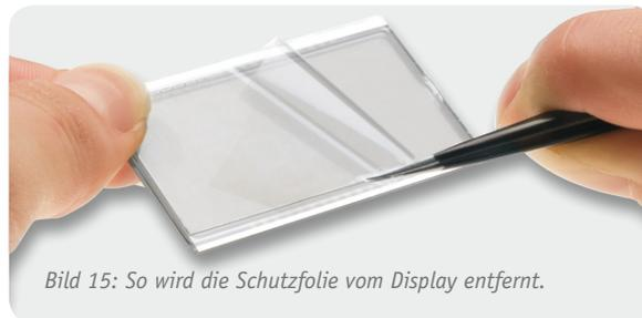
Bild 15: So wird die Schutzfolie vom Display entfernt.
