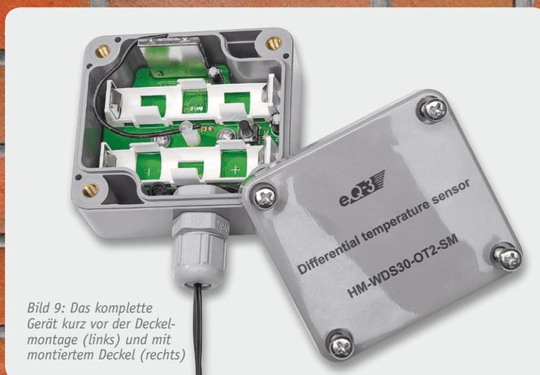
Bild 9: Das komplette Gerät kurz vor der Deckelmontage (links) und mit montiertem Deckel (rechts)
