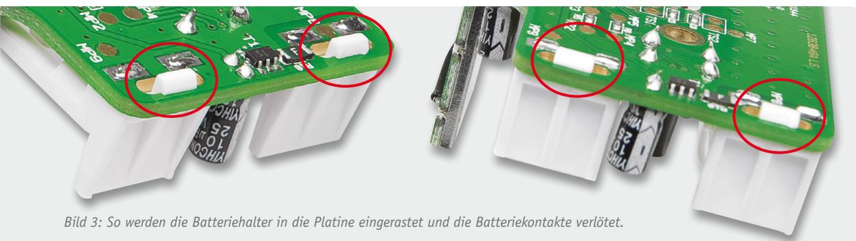
Bild 3: So werden die Batteriehalter in die Platine eingerastet und die Batteriekontakte verlötet.
