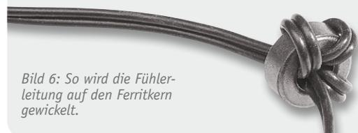
*Bild 6: So wird die Fühlerleitung auf den Ferritkern gewickelt.*
