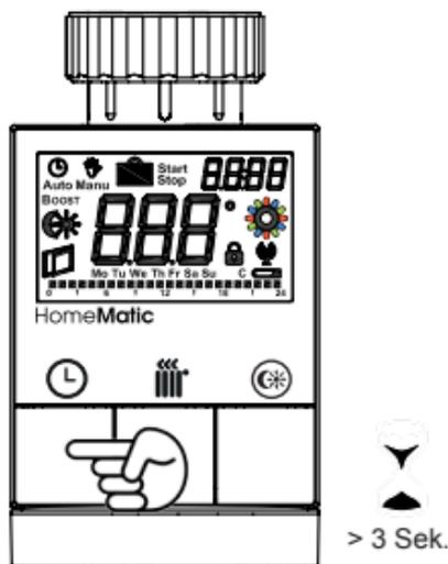
Menüpunkte werden mit dem Stellrad ausgewählt und mit der Boost-Taste (🔥) bestätigt. Ein erneuter Druck der Auto/Manu-Taste (🕒) führt zur vorherigen Ebene zurück. Nach jedem Menüpunkt wechselt das Display nach erfolgreicher Einstellung zurück zur normalen Displayanzeige. Wenn für mehr als 1 Minute keine Betätigung am Gerät erfolgt, schließt sich das Menü automatisch, ohne eingestellte Änderungen zu übernehmen.
