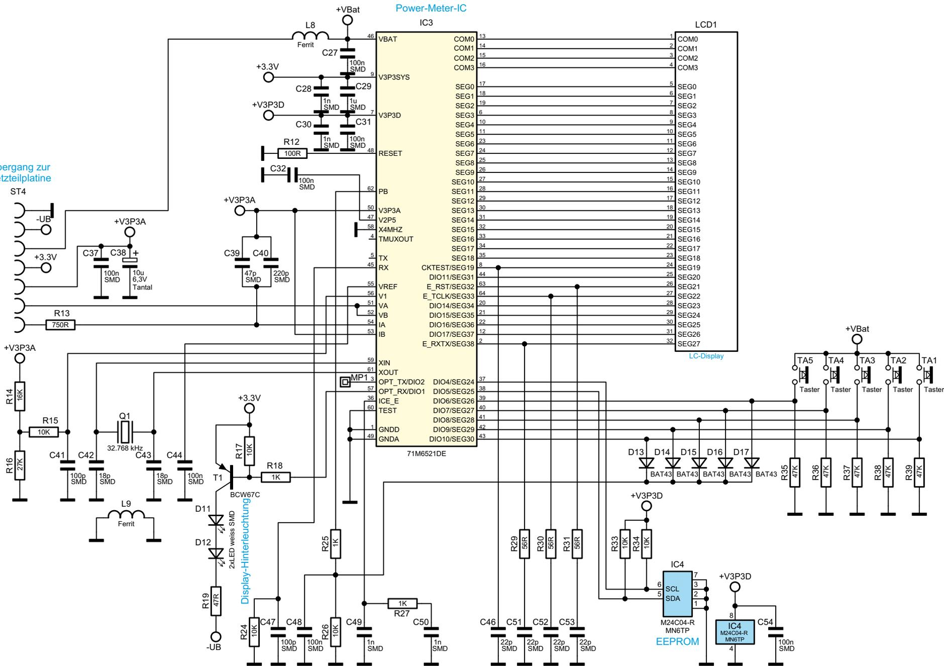
Bild 3: Hauptschaltbild mit Energie-Messchip und LC-Display
