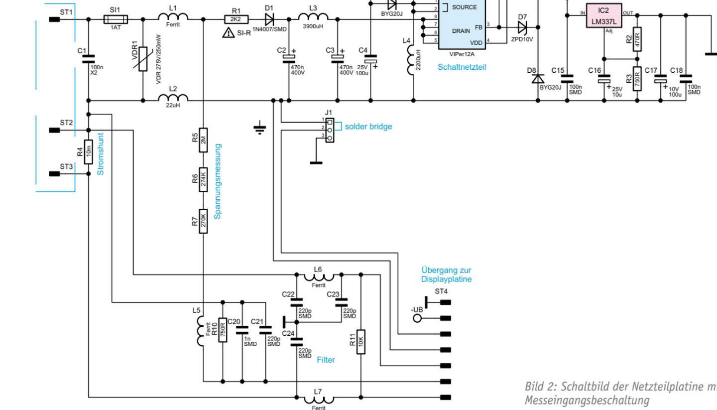
Bild 2: Schaltbild der Netzteilplatine mit Messingangsbeschaltung
