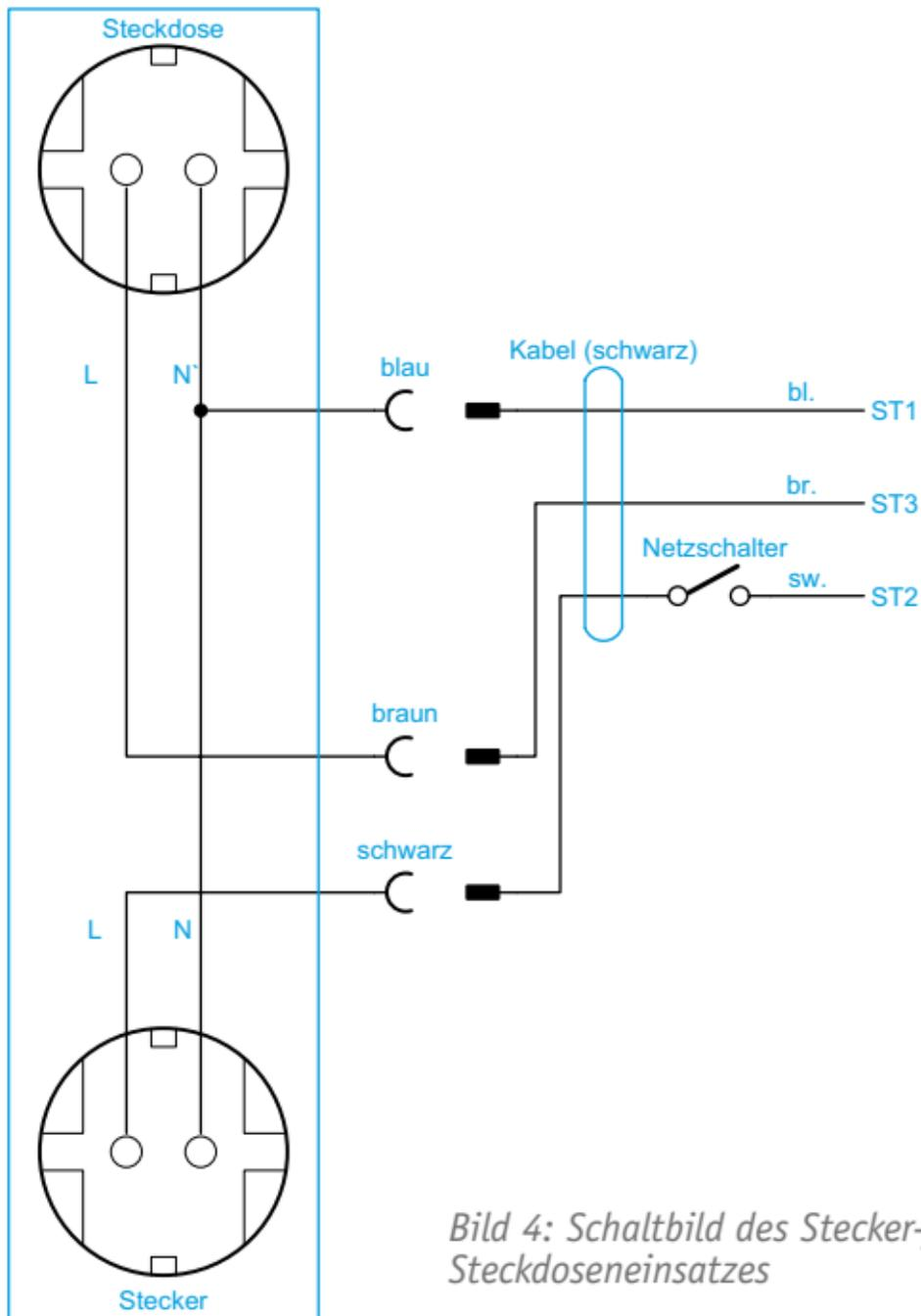
Bild 4: Schaltbild des Stecker-/ Steckdoseneinsatzes
