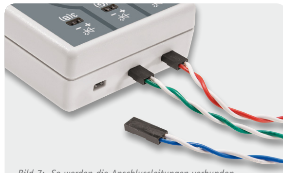
Bild 7: So werden die Anschlussleitungen verbunden.
