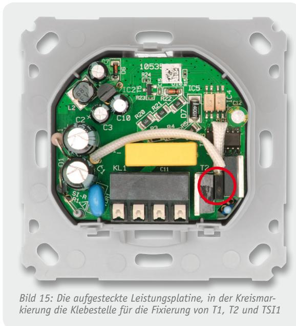
Bild 15: Die aufgesteckte Leistungsplatte, in der Kreismarkierung die Klebestelle für die Fixierung von T1, T2 und TSI1
