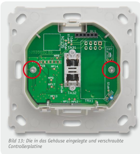
Bild 13: Die in das Gehäuse eingelegte und verschraubte Controllerplatine
