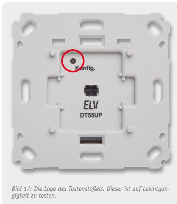
Bild 17: Die Lage des Tastenstößels. Dieser ist auf Leichtgängigkeit zu testen.
