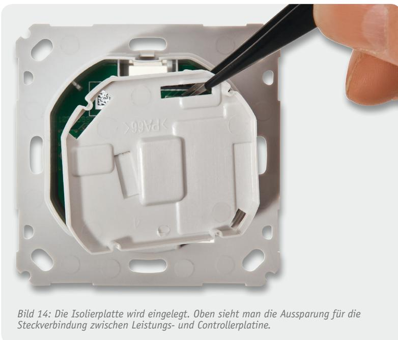
Bild 14: Die Isolierplatte wird eingelegt. Oben sieht man die Aussparung für die Steckverbindung zwischen Leistungs- und Controllerplatine.
