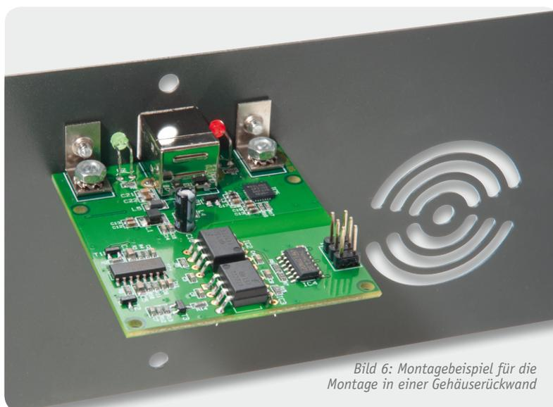
Bild 6: Montagebeispiel für die Montage in einer Gehäuserückwand
