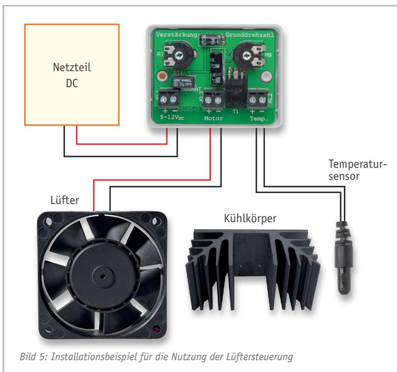
Bild 5: Installationsbeispiel für die Nutzung der Lüftersteuerung
