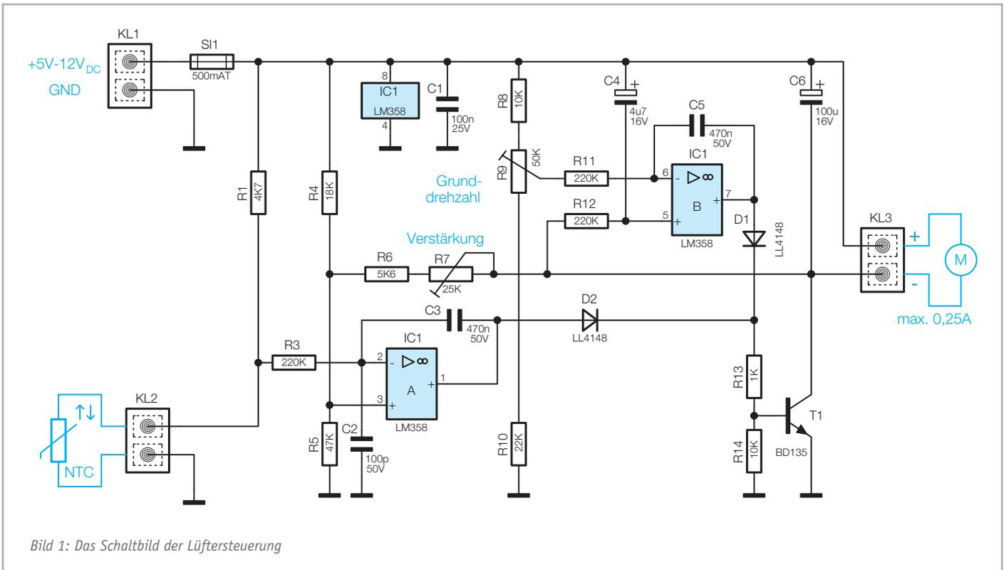
Als Stellglied fungiert der Leistungstransistor T1 des Typs BD135. Er ist im Massezweig des Lüfters eingesetzt, wodurch hier bei voller Durchsteuerung lediglich ein Spannungsabfall von ca. 150 mV entsteht, d. h., der Lüfter erreicht nahezu seine volle Leistung.
