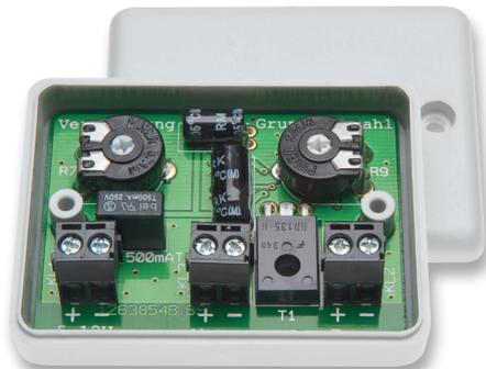
Bild 4: Die fertig aufgebaute Steuerung, in das optionale Gehäuse eingelegt
