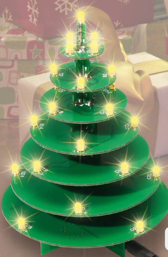
Bild 15: Der fertig aufgebaute LED-Weihnachtsbaum mit Steckernetzteil
