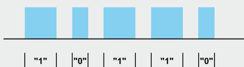
Bild I: Grundprinzip der Pulslängenmodulation
