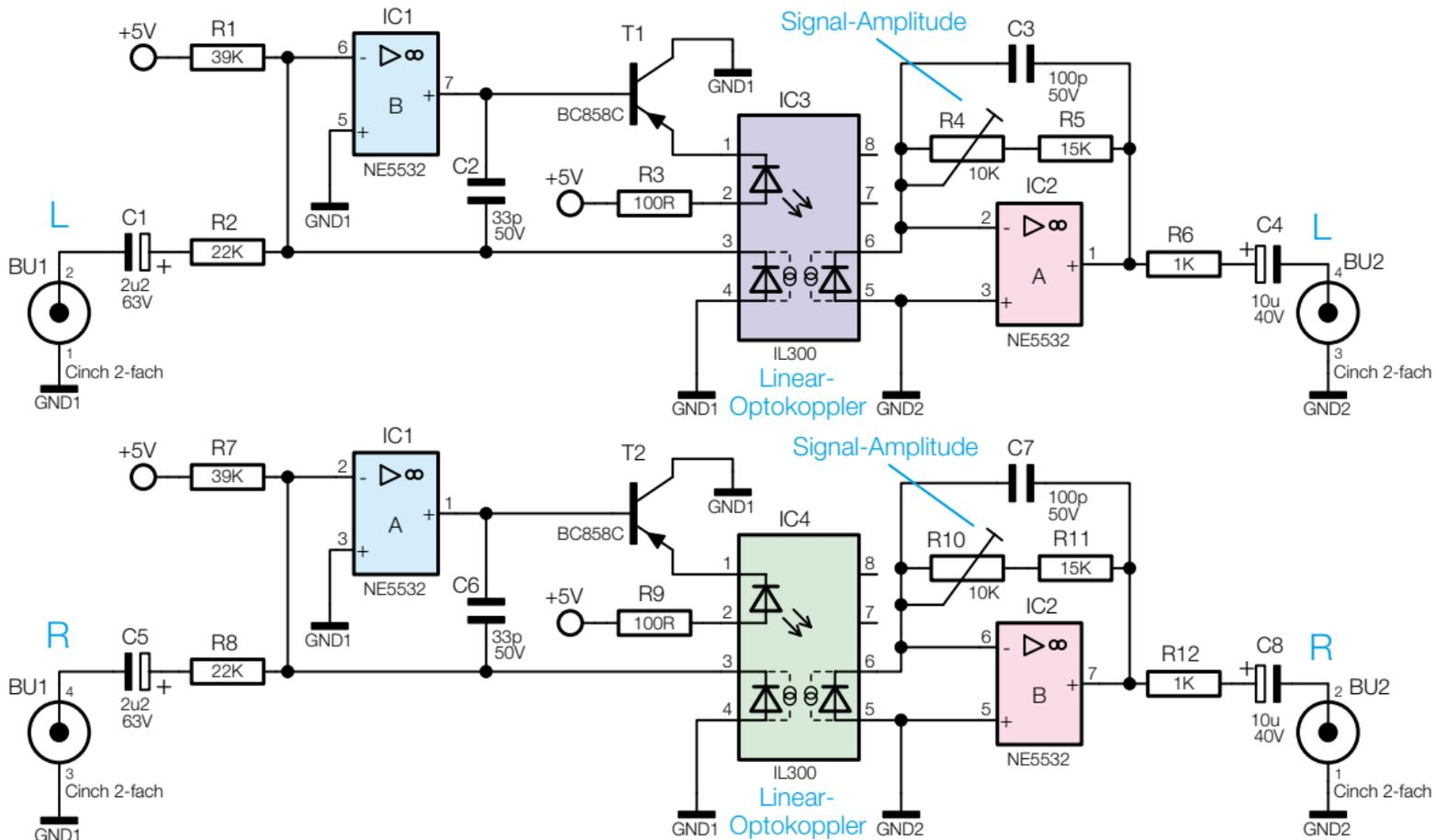
Bild 1: Schaltung des Stereo-Trennverstärkers
