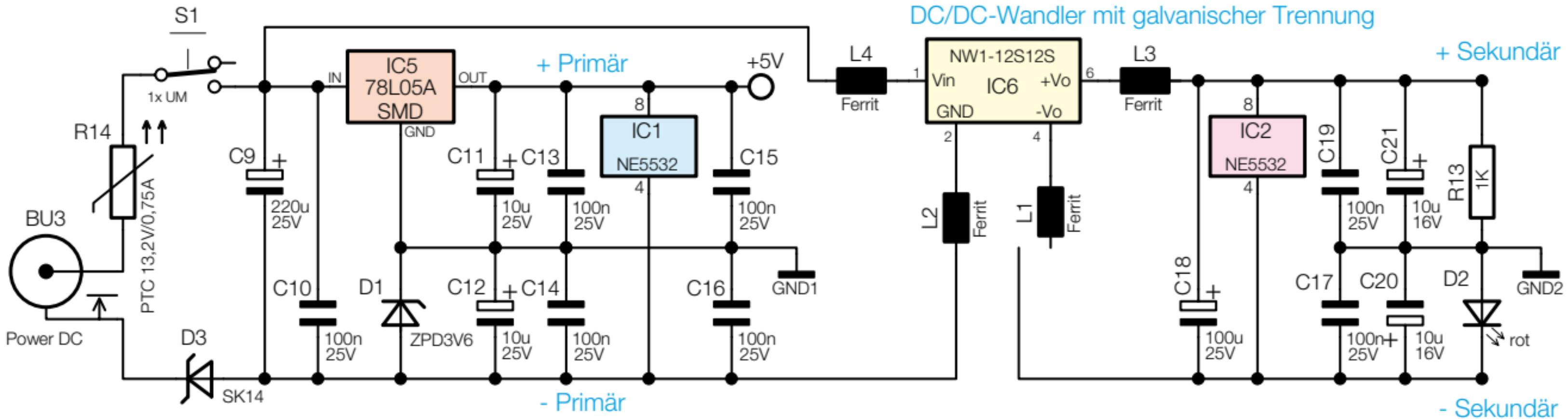
Bild 2: Netzteilerschaltung des OTV100
