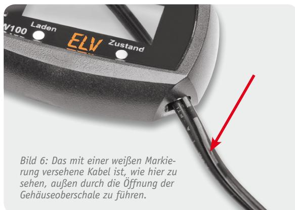
Bild 6: Das mit einer weißen Markierung versehene Kabel ist, wie hier zu sehen, außen durch die Öffnung der Gehäuseoberseite zu führen.
