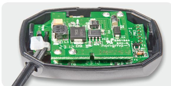
Bild 9: Die in die Gehäuseoberseite eingelegte Platine
