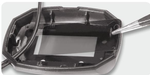
Bild 8: Das Einsetzen der Tönungsfolie für die Anzeige
