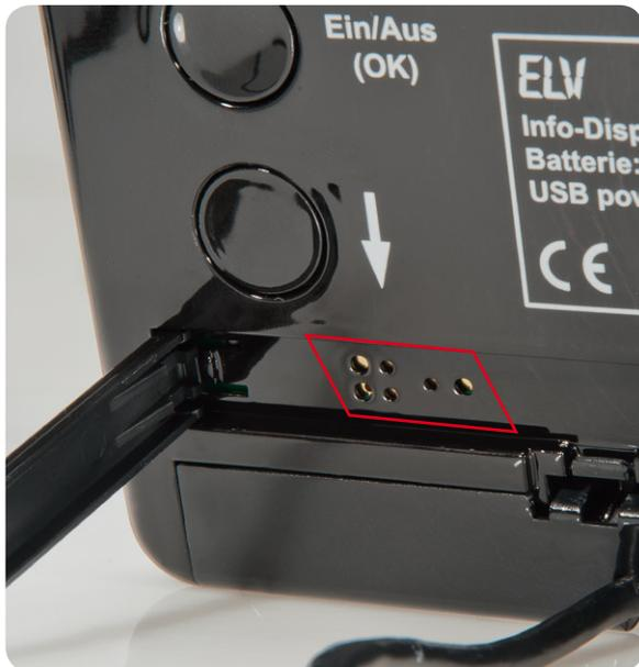
Bild 13: In den im Foto markierten Bereich wird der unbedruckte Aufkleber eingeklebt.
