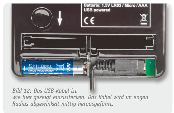
Bild 12: Das USB-Kabel ist wie hier gezeigt einzustecken. Das Kabel wird im engen Radius abgewinkelt mittig herausgeführt.
