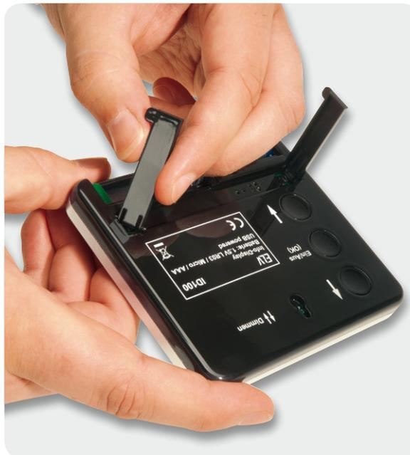
Bild 14: Die ausklappbaren Gerätefüße werden eingesetzt.
