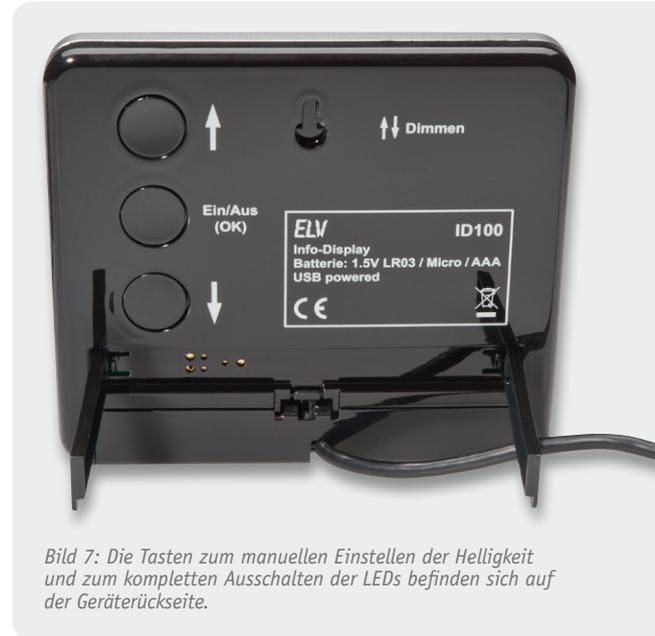
*Bild 7: Die Tasten zum manuellen Einstellen der Helligkeit und zum kompletten Ausschalten der LEDs befinden sich auf der Geräterückseite.*
