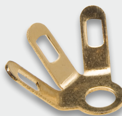
Bild 21: Die Dreifach-Lötöse ist für die Montage vorzubereiten, indem die einzelnen Lötösen hochgebogen werden.
