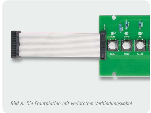
Bild 8: Die Frontplatine mit verlötetem Verbindungskabel
