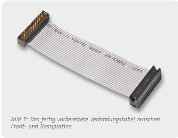
Bild 7: Das fertig vorbereitete Verbindungskabel zwischen Front- und Basisplatine
