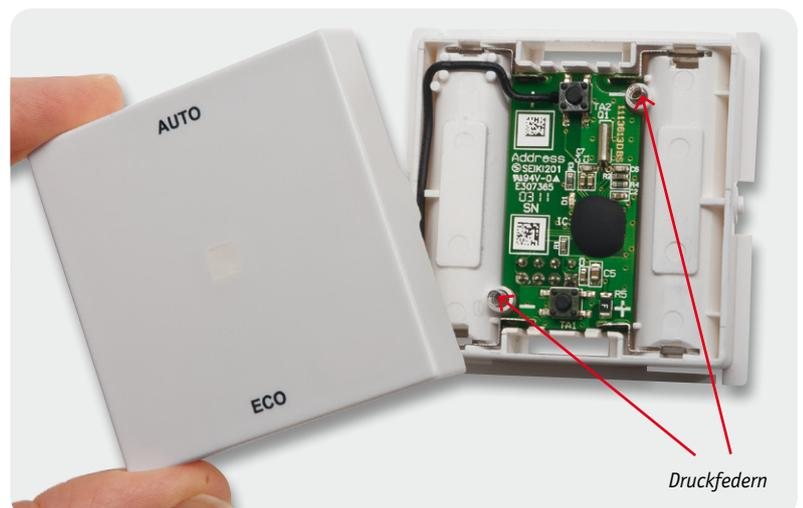
Bild 7: Schließen des Eco-Taster-Gehäuses
