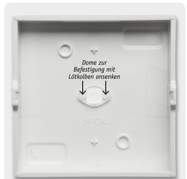
Bild 6: Befestigung des Lichtleiters
