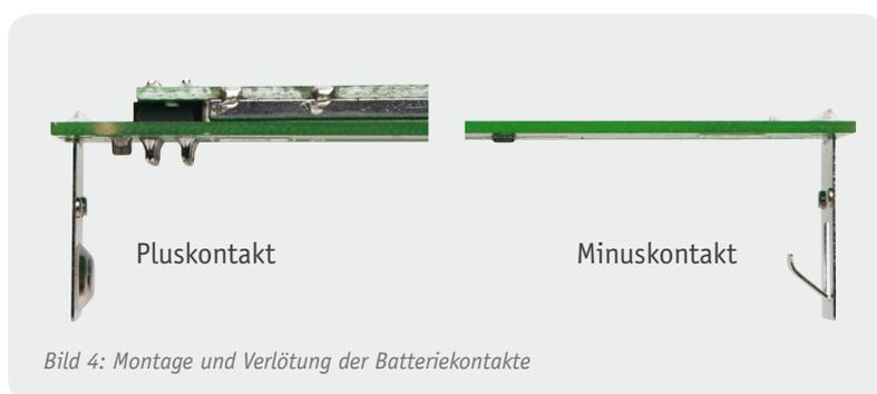
Bild 4: Montage und Verlotung der Batteriekontakte
