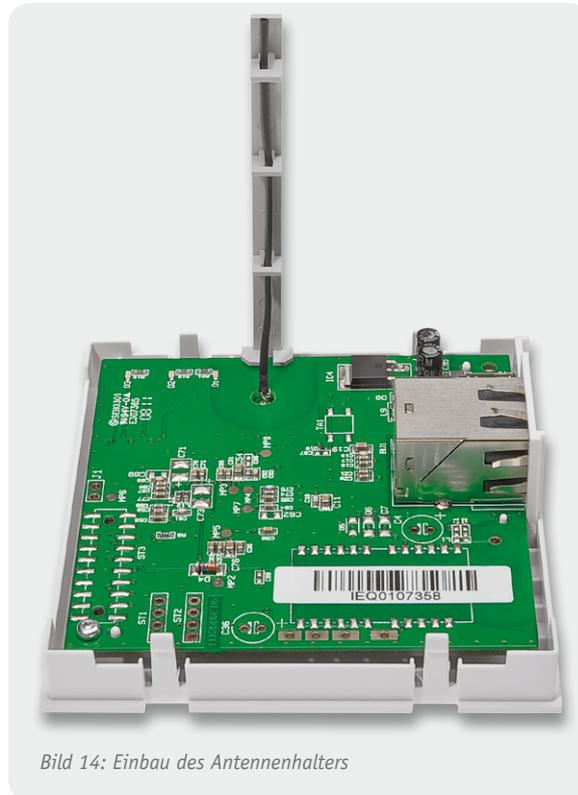
Bild 14: Einbau des Antennenhalters
