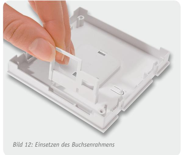
Bild 12: Einsetzen des Buchsenrahmens
