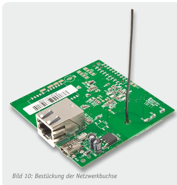
Bild 10: Bestückung der Netzwerkbuchse
