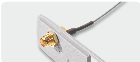
Bild 11: Montage von Antennenbuchse und Antennenkabel am Gehäuse-Seitenteil
