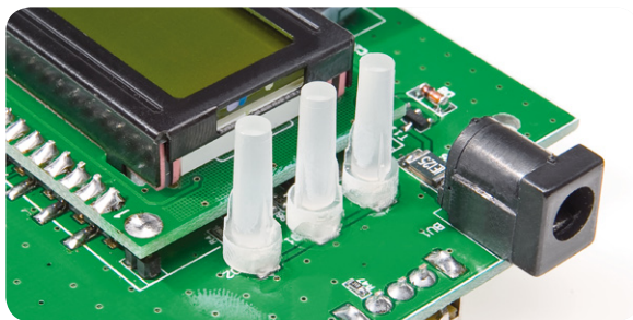
Bild 9: Die 3 mit Klebstoff fixierten Lichtleiter
