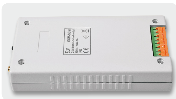
Bild 17: Gehäuse-Ober- und -Unterschale werden mit 4 Schrauben verbunden.
