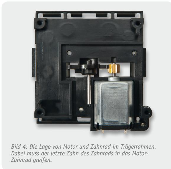
Bild 4: Die Lage von Motor und Zahnrad im Trägerrahmen. Dabei muss der letzte Zahn des Zahnrad in das Motor-Zahnrad greifen.
