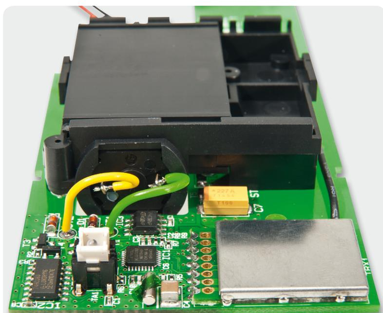
Bild 13: Die Motoranschlüsse und die zugehörigen Platinen-Anschlusspunkte werden über kurze Leitungstücke verbunden.
