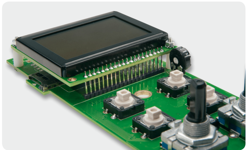
Bild 5: Blick auf die Stiftleiste für das Display
