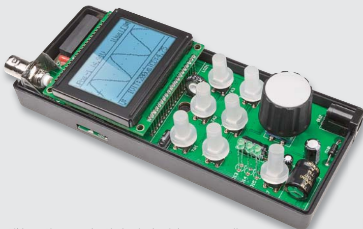
Bild 23: Einsetzen der Platine in das Gehäuseunterteil
