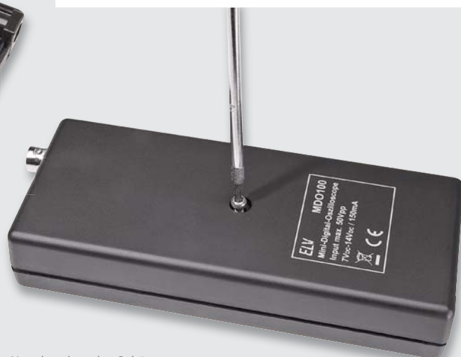
Bild 24: Verschrauben des Gehäuses
