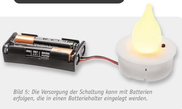
Bild 5: Die Versorgung der Schaltung kann mit Batterien erfolgen, die in einen Batteriehalter eingelegt werden.
