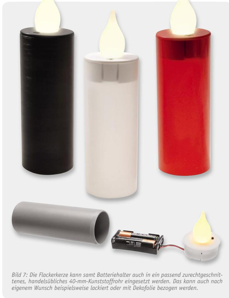
Bild 7: Die Flackerkerze kann samt Batteriehalter auch in ein passend zurechtgeschnittenes, handelsübliches 40-mm-Kunststoffrohr eingesetzt werden. Das kann auch nach eigenem Wunsch beispielsweise lackiert oder mit Dekofolie bezogen werden.
