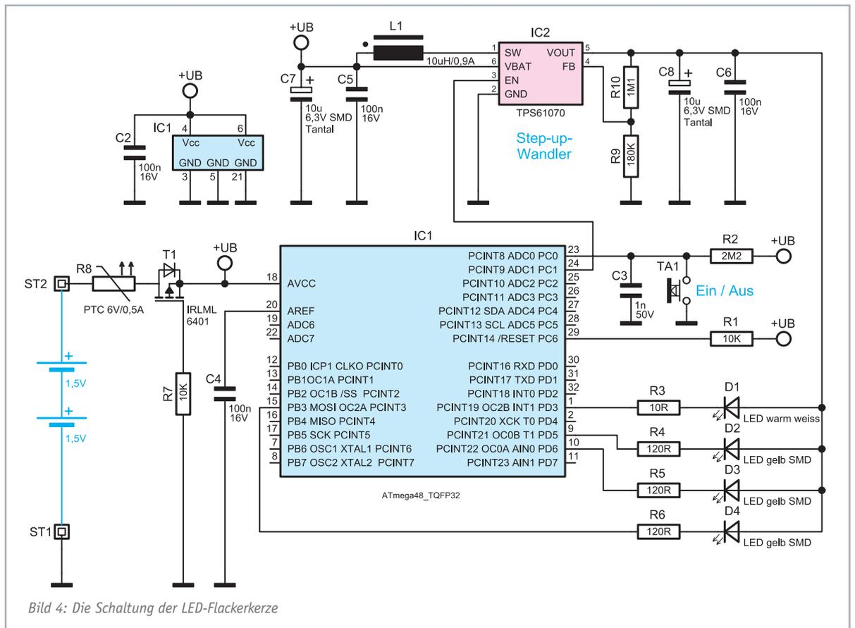
Bild 4: Die Schaltung der LED-Flackerkerze
