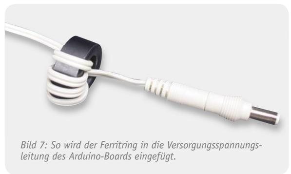
Bild 7: So wird der Ferritring in die Versorgungsspannungszuleitung des Arduino-Boards eingefügt.
