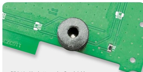
Bild 10: Abschattung des Spezialchips zur Gestenerkennung mit einem Kunststoffring
