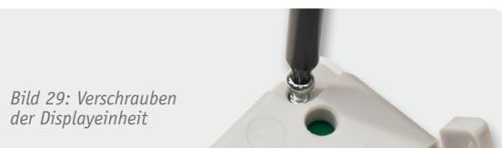
Bild 29: Verschrauben der Displayeinheit
