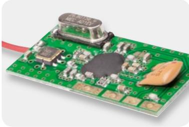
Bild 20: 868-MHz-Funkempfänger
