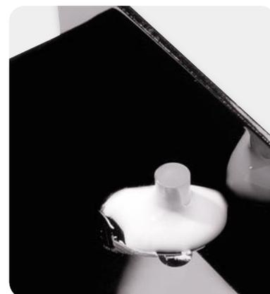
Bild 26: Einkleben eines Lichtleiters für die Duo-LED im Gehäuseoberteil
