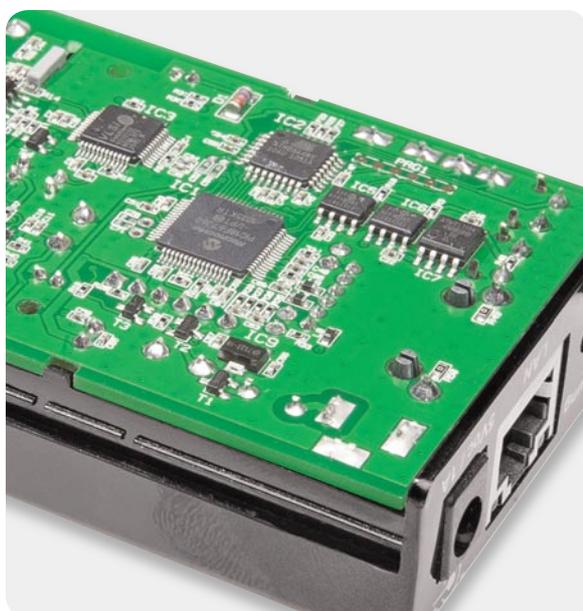
Bild 27: Einsetzen der Platine im Gehäuseoberteil
