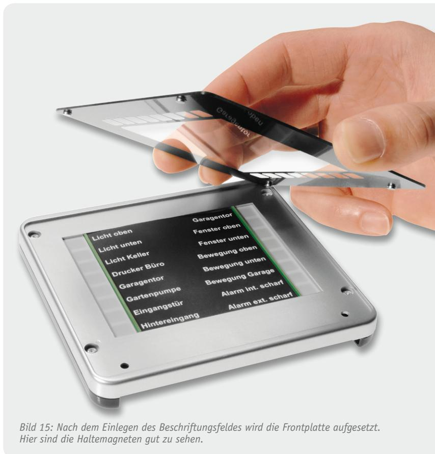
Bild 15: Nach dem Einlegen des Beschriftungsfeldes wird die Frontplatte aufgesetzt. Hier sind die Haltemagneten gut zu sehen.
