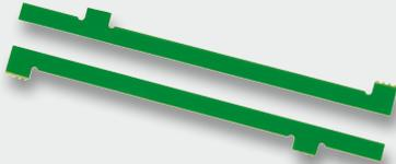
Bild 5: Die beiden herausgebrochenen Stege sind ggf. nachzubearbeiten (Bruchkante glätten/entgraten).
