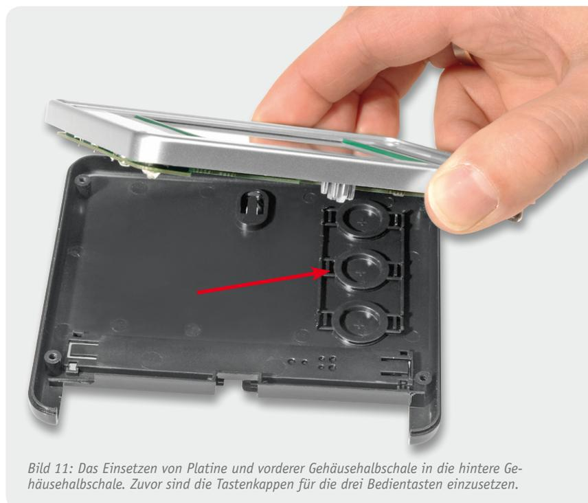
Bild 11: Das Einsetzen von Platine und vorderer Gehäusehälschale in die hintere Gehäusehälschale. Zuvor sind die Tastenkappen für die drei Bedientasten einzusetzen.
