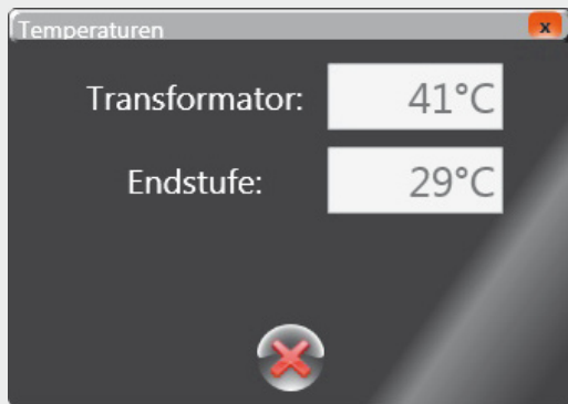
Bild 40: Anzeige der Trafo- und Endstufen-Temperatur des DPS 5315
